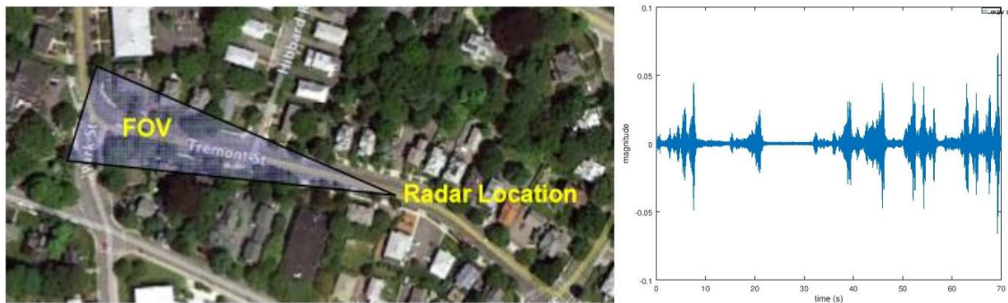
Gambar 3.2. Lanskap pemindaian radar dan sinyal hasil yang didapat
