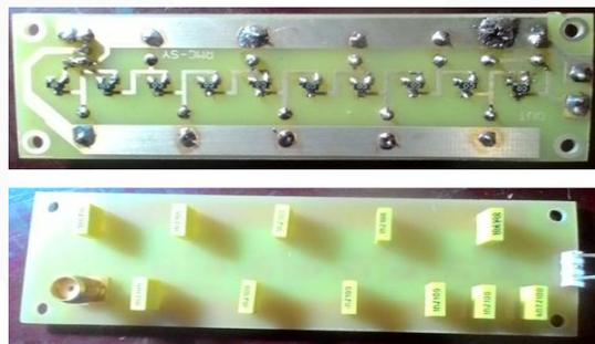
Gambar 9. Rangkaian Rectifier
