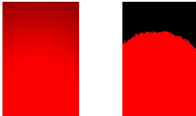
Gambar 3. Frame sebelum thresholding (kiri) dan frame setelah thresholding (kanan)
