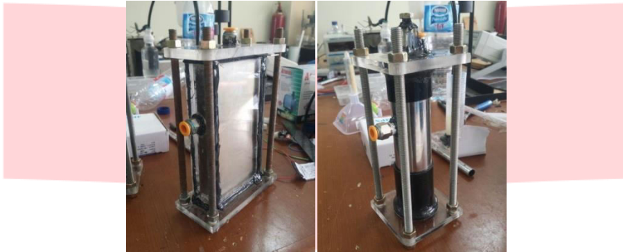
Gambar 4.1 Generator HHO Bentuk Plat dan Bentuk Silinder
