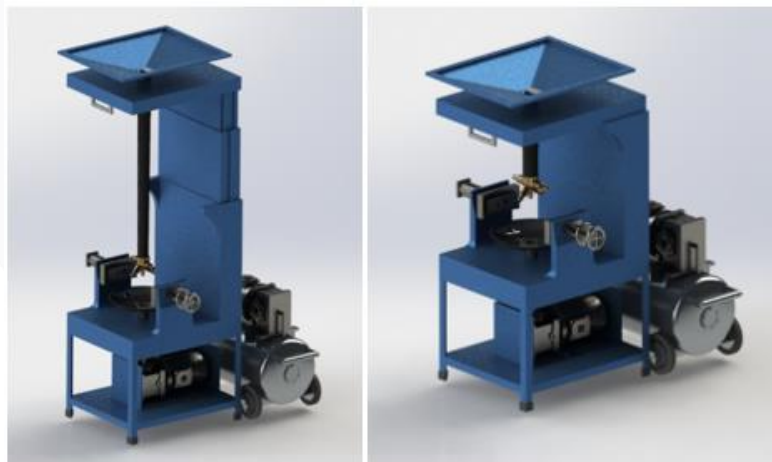
Gambar 8 Spesifikasi dan Desain Akhir Mesin Sandblasting.
