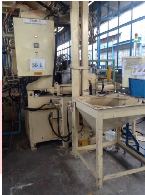
Gambar 1 Mesin Saat ini pada Proses Sandblasting
