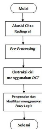
Gambar 6. Diagram Alir Sistem Secara Umum
