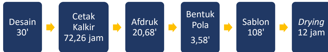
Gambar I.2 Aliran Proses Produksi Percetakan CV Plasmagraph
