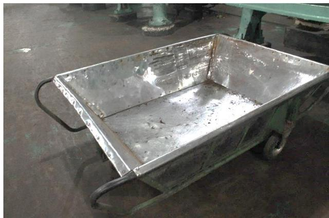
**Gambar I. 2 Alat Pengangkut daun pada Proses Penggilingan *Ortodox***
