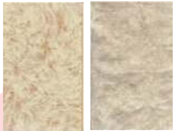
Gambar 4.2 Hasil Proses Felting Serat Kapuk Menggunakan Teknik Pengkanjian
