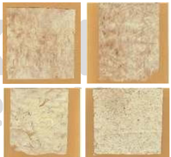
Gambar 4.3 Hasil Proses Felting terhadap Serat Kapuk Menggunakan Penambahan Larutan NaOH
