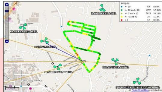
Gambar 4.8 Hasil drive test parameter SINR setelah optimasi
