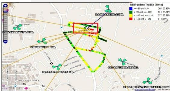
Gambar 4.2 Hasil drive test parameter RSRP sebelum optimasi
