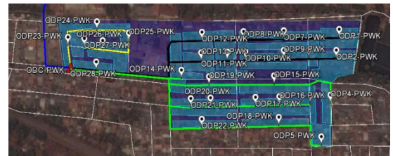
Gambar 3.8 Perancangan Kabel Distribusi Tabel 3.2 Keterangan Kabel Distribusi
