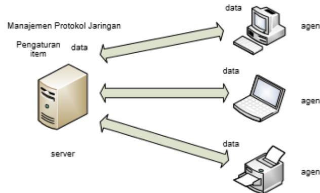
Gambar 2.1 Proses di dalam *Network Management System*<sup>[6]</sup>
