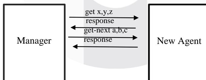
Gambar 2.4 Interaksi Perintah Dasar Pada SNMP
