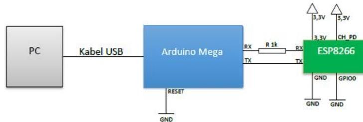
Gambar 8. Datasheet penulisan program ke ESP8266
