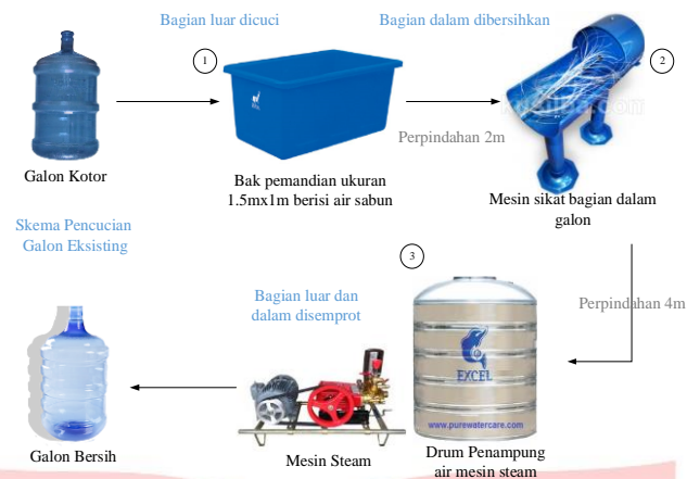
Gambar 1. Skema pencucian galon di CV. Barokah Abadi
