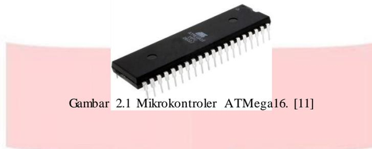
Gambar 2.1 Mikrokontroler ATmega16. [11]
