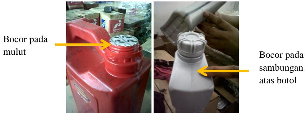
Gambar I. 4 Cairan pelumas keluar pada bagian atas botol
