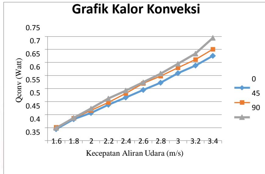
Gambar 5.5. Grafik Kalor Konveksi Terhadap Kecepatan Aliran Udara
