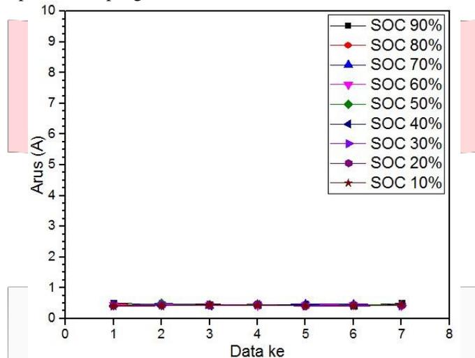
Gambar 10. Grafik Perbandingan Antara SOC dan Arus Baterai Pada Siklus Pengosongan
