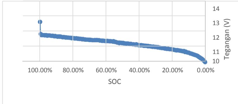
Gambar 9. Grafik Perbandingan Antara SOC dan Tegangan Baterai Pada Siklus Pengosongan
