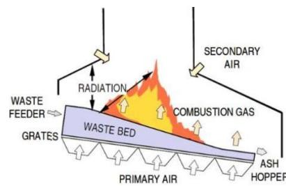
**Gambar 3. 2 Skema pembakaran pada model bed insinerator.**
