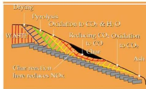
**Gambar 2. 2** Zona zona didalam proses insinerasi
