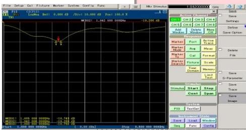
Gambar 4.1 Hasil pengukuran *return loss* input
