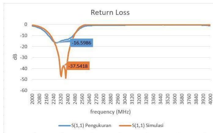
Gambar 8 Hasil perbandingan simulasi dan pengukuran return loss
