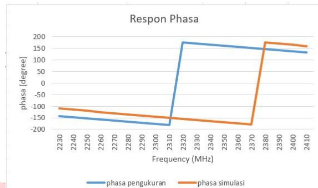
Gambar 10 Hasil simulasi dan pengukuran beda fasa BPF
