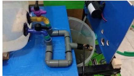
Gambar 4.1 pengujian flow meter
