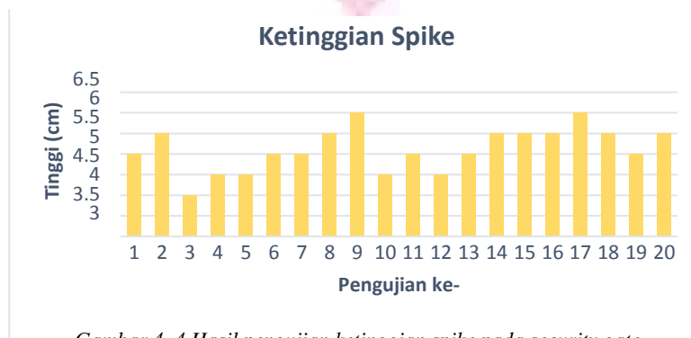
Gambar 4. 4 Hasil pengujian ketinggian spike pada security gate
