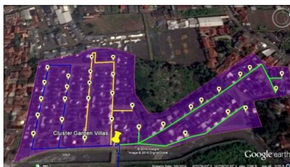
Gambar 4 Perancangan Kabel Distribusi Skenario 1
