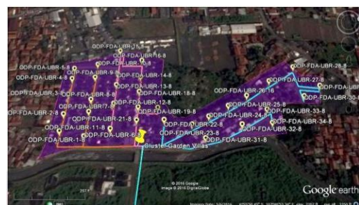
Gambar 7 Peletakan ODP Skenario 2
