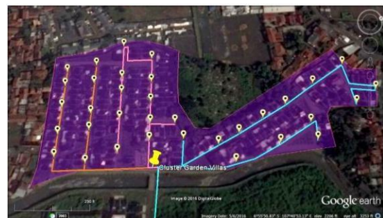
Gambar 5 Perancangan Kabel Distribusi Skenario 2
