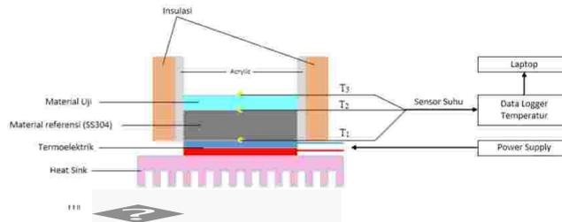
Gambar Error! No text of specified style in document..1 Perancangan sistem pengukuran konduktivitas termal material cair
