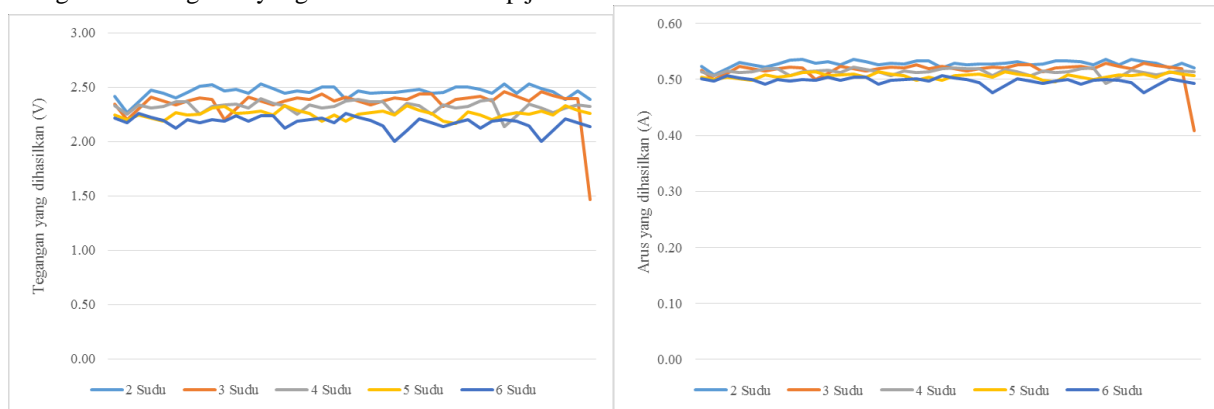
Gambar 10. Grafik Tegangan dan Arus yang dihasilkan setiap Sudu pada Kecepatan Angin 5 m/s
