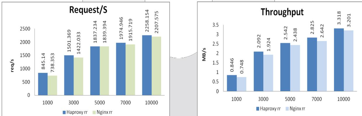
Gambar 4.5 Perbandingan Req/s dan Throughput Haproxy dengan Nginx
