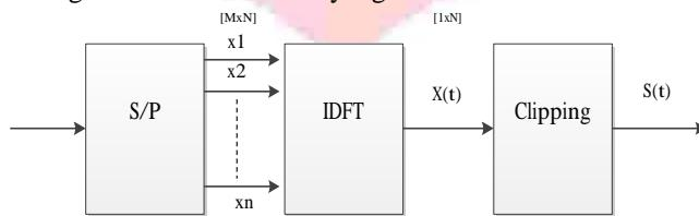
**Gambar 3 Skema Kinerja Clipping[1]**
