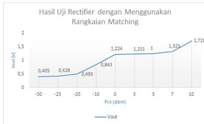
Gambar 4. 2 Grafik hasil uji rectifier dengan menggunakan rangkaian matching
