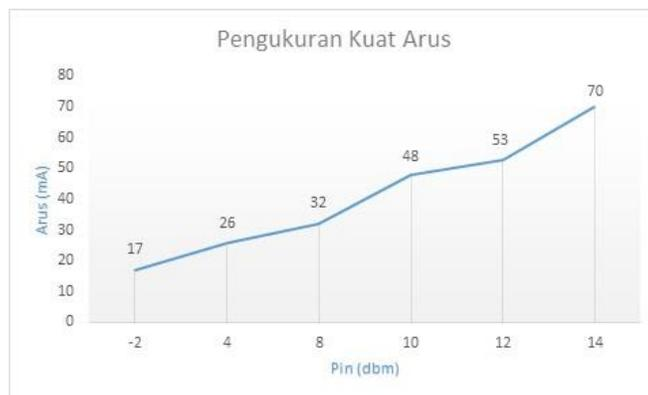
**Gambar 4. 4** Grafik pengukuran kuat arus pada rangkaian
