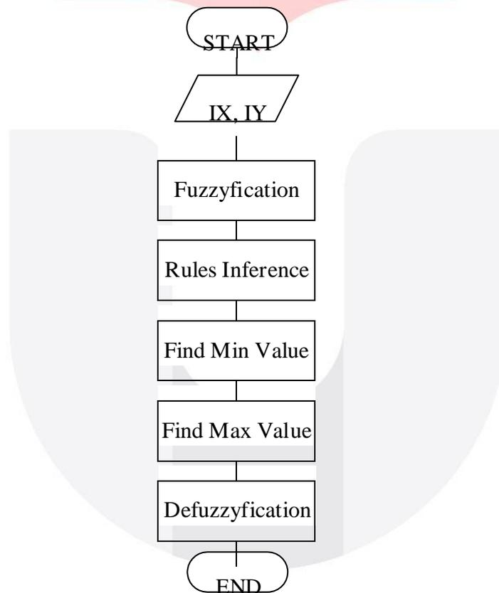
Gambar 6. Diagram Alir Perancangan *Fuzzy Logic*
