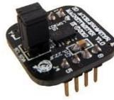
Gambar 2. 3 DT-Sense Accelerometer Magnetometer<sup>[10]</sup>.
