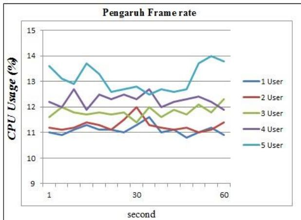
Gambar 17 Grafik CPU Usage Pengaruh Frame rate
