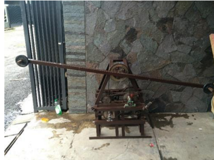
Gambar 3 pembangkit listrik teanga gelombang Tampak Depan
