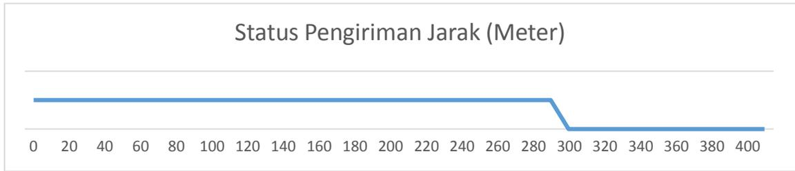
Hasil pengujian jarak komunikasi dengan STS dapat disimpulkan bahwa jarak ideal data yang diterima sesuai dengan data yang dikirim yaitu 300 meter pada lapangan terbuka, terjadi penurunan kualitas sinyal apabila ujicoba dilakukan pada jarak lebih dari 300 meter.
