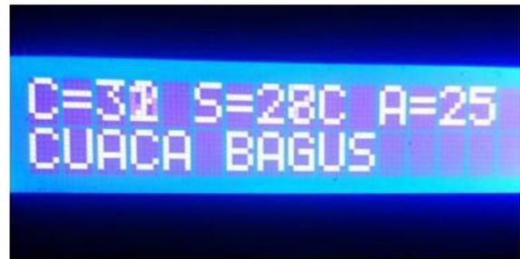
Gambar 14 Tampilan LCD Kondisi saat Cuaca Bagus
