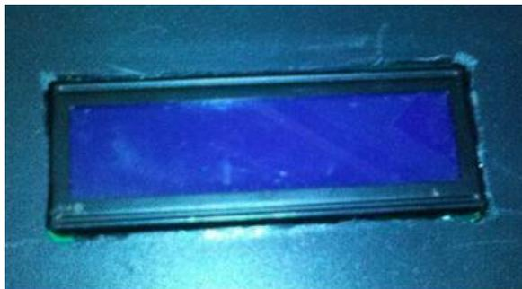
Gambar 11 LCD 16x2
