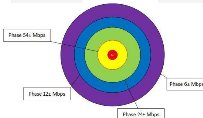
Gambar 2 Pembagian kelas *bit rate* berdasarkan jarak
