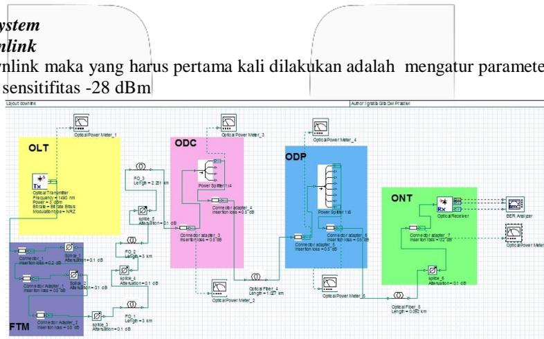
Gambar 4.1 Konfigurasi Downlink
