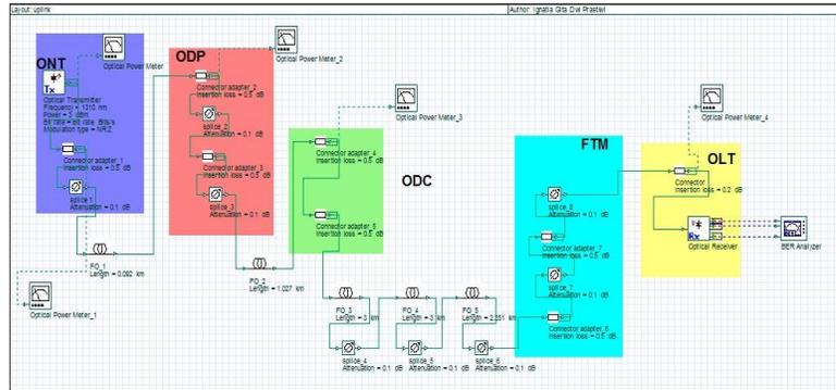
Gambar 4.2 Konfigurasi Uplink
