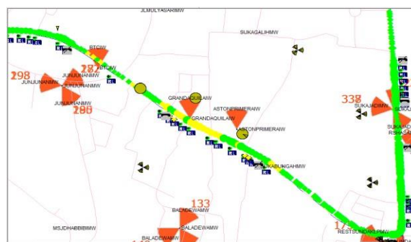
Gambar 5 Hasil Pengukuran Drive Test sebelum optimasi pada rute Pintu Tol Pasteur – PVJ
