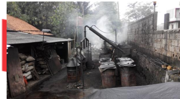
Gambar 2.2 Pengolahan asap cair (Sumber : Data Penulis, 2015)
