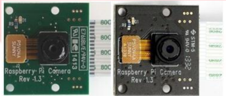
Gambar 2.2 Modul Picamera IR dan NoIR (sumber: www.elinux.org )
