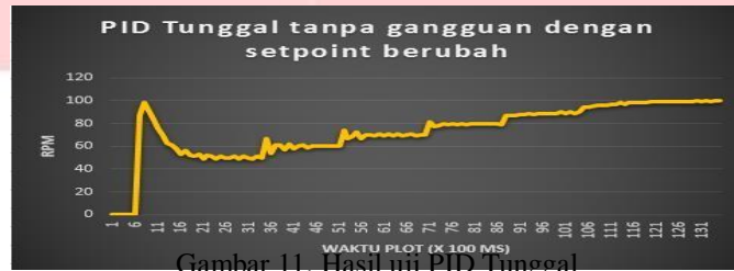
Gambar 11. Hasil uji PID Tunggal
