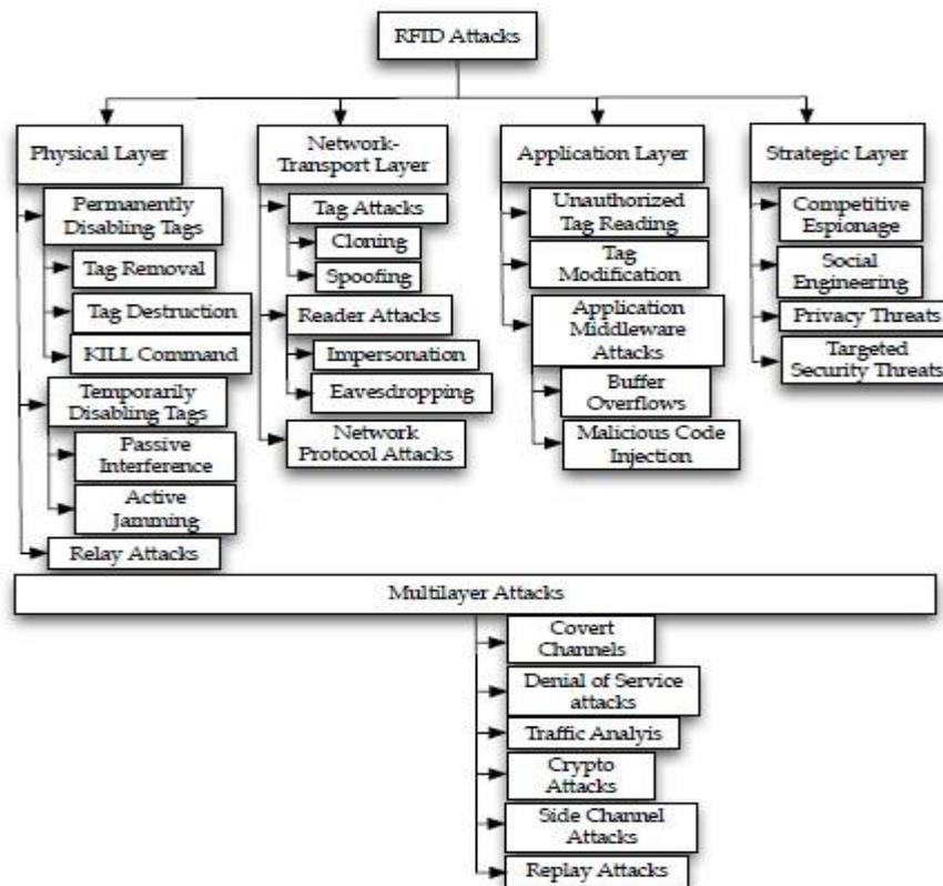
Gambar 2 Jenis serangan pada RFID[9]
