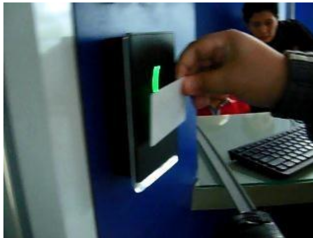
Gambar 6 Tes membuka pintu perpustakaan dengan cloning
