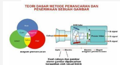
Gambar 1 Prinsip kerja kamera [2].
