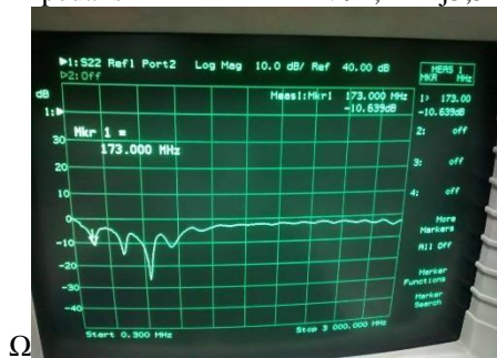
GAMBAR 4 4 (HASIL PENGUKURAN RETURN LOSS ANTENA TX)
