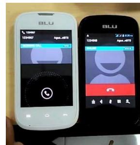
**Gambar 4.1** Pengujian komunikasi suara dari nomor 1234567 ke 1234568
