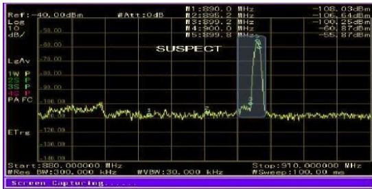
Gambar 3.9 Scanning dengan antenna omnidirectional
