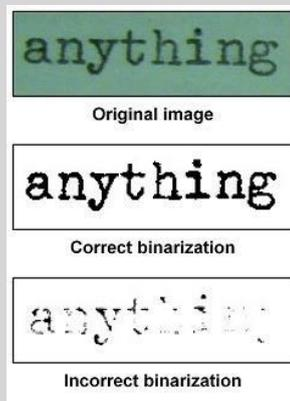
Gambar 2.1: Contoh gambar yang mengalami *binarization* sebagai salah satu contoh proses OCR OpenCV
