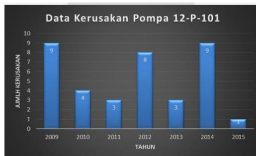
Gambar 1-1 Grafik Kerusakan Pompa 12-P-101
