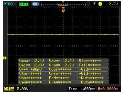
Gambar 4.3 Sinyal Sumber Tegangan Isolator Pulsa
