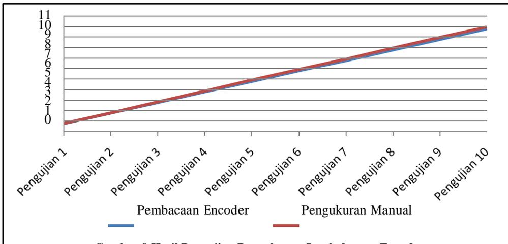
Gambar 8 Hasil Pengujian Pengukuran Jarak dengan Encoder
