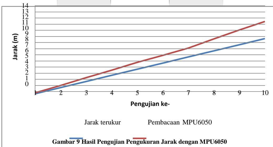
Gambar 9 Hasil Pengujian Pengukuran Jarak dengan MPU6050
