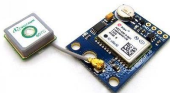
Gambar 4: U-Blox GPS NEO-6M
